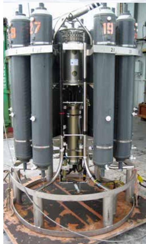
Un primer plano de un CTD, la herramienta principal utilizada para mapear penachos hidrotermales. Un anillo de botellas de muestreo de plástico rodea el CTD, que se aloja en el contenedor de acero en el centro de la roseta. Los sensores CTD se pueden ver en la parte inferior de la caja de presión. Imagen: NOAA Vents Program.
