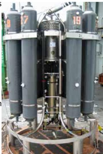
Un primer plano de un CTD, la principal herramienta usada para mapear penachos hidrotermales. Un anillo de botellas de muestreo de plástico rodea al CTD, que se aloja en el recipiente de acero en el centro de la roseta. Los sensores CTD son visibles en la parte inferior de la caja de presión. Imagen: NOAA Vents Program.
