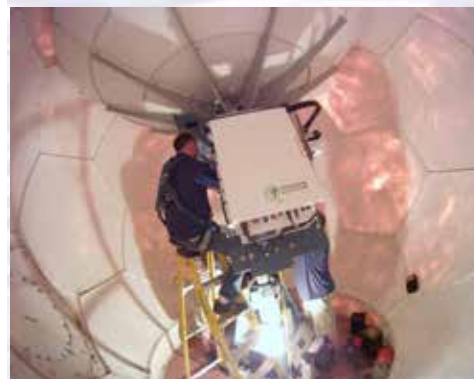
Los técnicos trabajan en la antena de satélite en el domo VSAT. Imagen: NOAA Okeanos Explorer Program, Galapagos Rift Expedition 2011.
