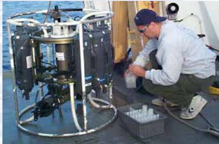
Un CTD está amarrado a una estructura metálica llamada roseta, o carrusel, junto con numerosas botellas de muestreo de agua y cuando se despliega, proporciona información sobre la composición de la columna de agua. Imagen: NOAA.
