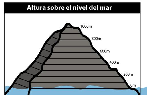
Un ejemplo básico de una montaña con líneas de contorno. Los científicos miden las alturas de las montañas desde el nivel del mar hacia arriba. La línea horizontal inferior está al nivel del mar (0 metros). Ilustración cortesía de NOAA Ocean Exploration.
