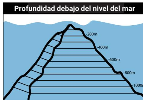
Una ilustración básica de un monte submarino con curvas de nivel. Los científicos miden las alturas de los montes submarinos desde el nivel del mar hacia abajo. La primera profundidad marcada es de 200 metros por debajo del nivel del mar. Ilustración cortesía de NOAA Ocean Exploration.
