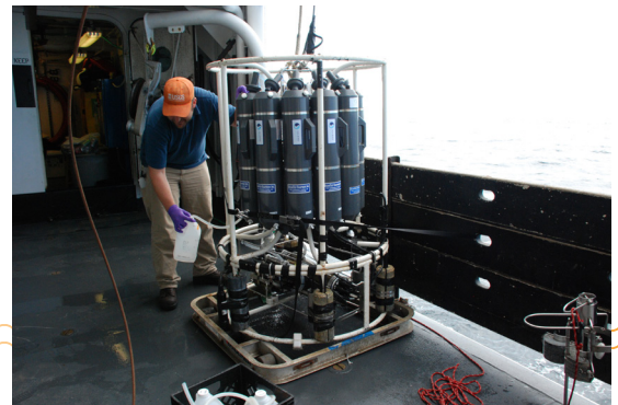
Se conecta un tubo a cada botella Niskin en esta roseta CTD para transferir muestras de agua a jarras de plástico para su procesamiento. Imagen por cortesía de NOAA Ocean Exploration/BOEM/USGS.
