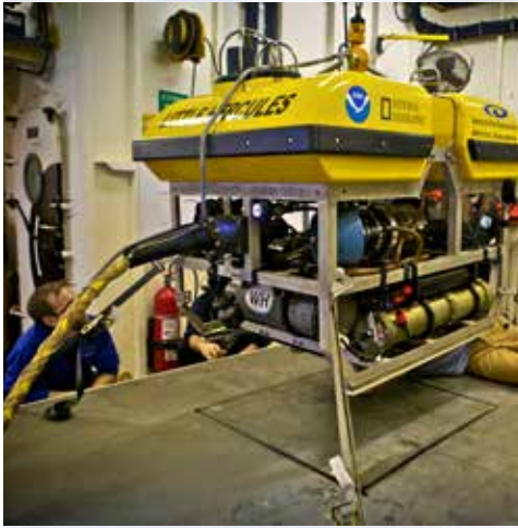
El equipo probó el mecanismo de desenganche de Little Hercules en el gancho del ROV. Imagen: NOAA Okeanos Explorer Program. http://oceanexplorer.noaa.gov/okeanos/explorations/ex1202/logs/hires/apr4-3-hires.jpg
